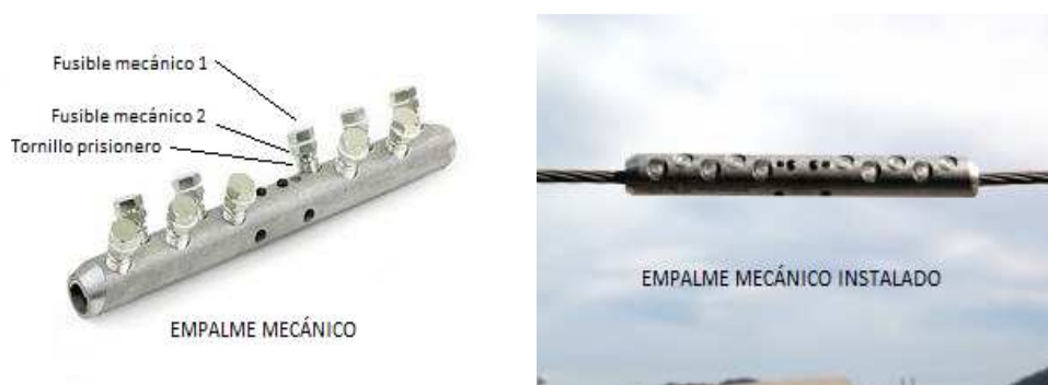
Figura 10.2: Empalme mecánico de tornillos prisioneros
