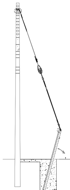
Figura 17.4: Retenida a perfil estructural en “I”
