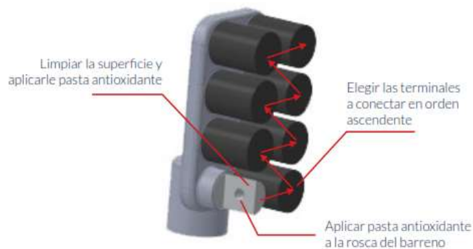
Figura No. 3.8 Componentes y orden de conexión de salidas de un conector tipo muelle de doble columna
