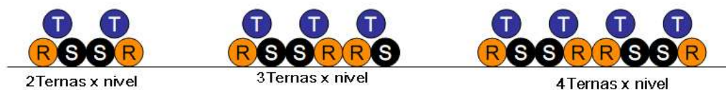
Figura No. 14. Disposición de cables en galerías
